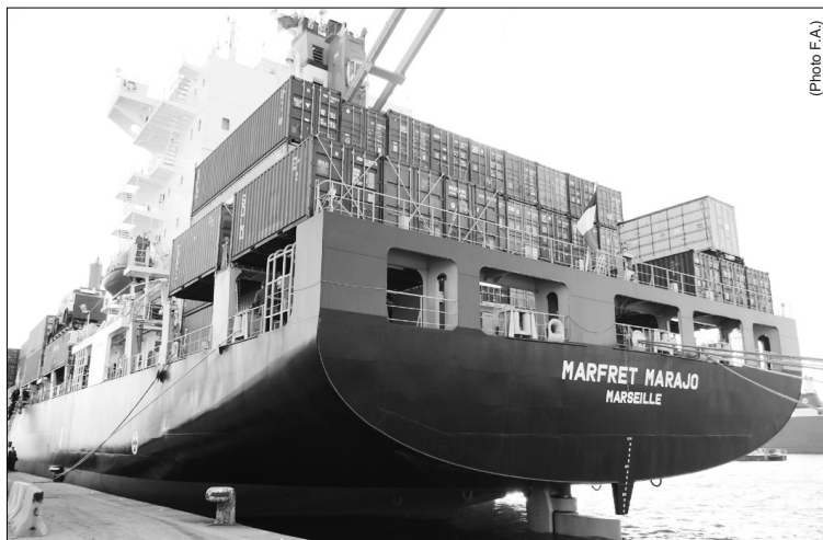
Le "Marfret Marajo" est un navire bigué d'une capacité de 1.691 Evp. Il mesure 170 m de long, 27,2 m de large et affiche 21.244 de tonnage de port en lourd.
